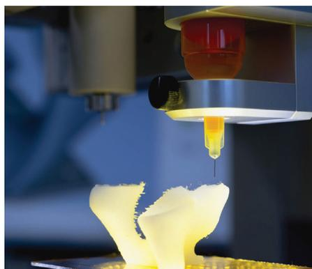
Il laboratorio si è anche dotato, recentemente, di due piattaforme per il Bioprinting. Questa innovativa tecnica, nell'ambito dell'ingegneria dei tessuti, consente la realizzazione di impianti custom-made, ovvero progettati sulla base di immagini cliniche ottenute dal paziente, in grado di imitare i tessuti naturali attraverso la deposizione controllata di una combinazione di biomateriali, cellule e stimoli bioattivi.
